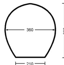
**Kreisform** (z.B. für „Agrosil“-Rohre): DN 150; DN 250; DN 350 \*
